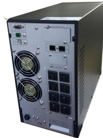
**Regulación de voltaje  $\pm 1\%$ , Capacidad de sobrecarga 105% continuamente, 125% por 60 segundos, 150% durante 2 segundos y transfiere la carga al Bypass , Recuperación ante transitorios  $<200\text{ms}$ , **bypass de estado sólido**, Ruido audible  $<55\text{ dba}$  1m panel frontal con indicadores tipo led span**
